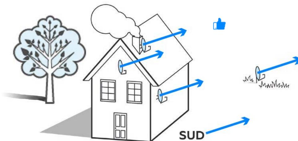
Votre parabole doit être orientée vers le sud/sud Est et vers le haut. Il est possible de l'installer en toute discrétion sur le toit, le pignon mais aussi sur un balcon ou dans le jardin (hors lieu de passage). Elle ne doit pas avoir de prise au vent. Le cerclage à une cheminée nécessite de s'assurer de la solidité sans faille de celle-ci.
