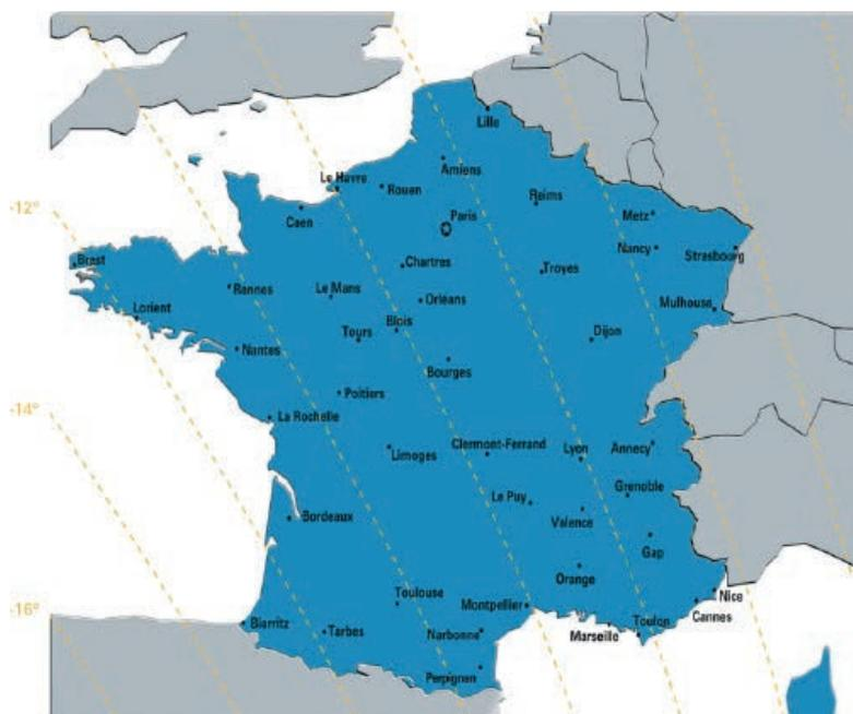
Exemple : à Biarritz, le LNB doit être tourné de 13° par rapport à la verticale, dans le sens des aiguilles d'une montre lorsque l'on regarde la parabole et que l'on est situé entre le satellite et la parabole.
