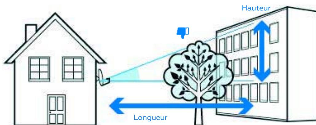
Si un obstacle (arbre, immeuble...) se trouve dans l'axe de visée du satellite, la parabole doit être placée à une distance minimum de 1,5 fois la différence entre la hauteur de l'obstacle et la hauteur de fixation de la parabole. Tenez compte du développement de la végétation qui pourrait empêcher la réception des signaux plus tard (feuillage, branches...).
